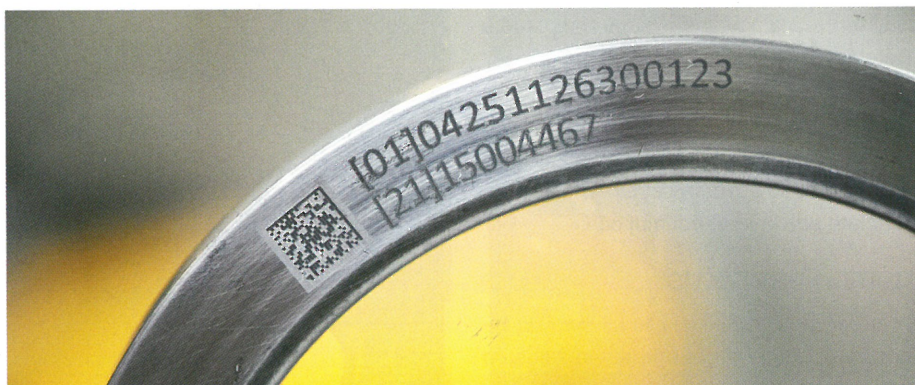
GS1 je skupaj z dvajsetimi partnerji iz železniškega gospodarstva razvil nove aplikacije za zagotavljanje identifikacije delov in komponent, kjer igrajo eno izmed ključnih vlog lasersko gravirane 2D-kode GS1 DataMatrix.
